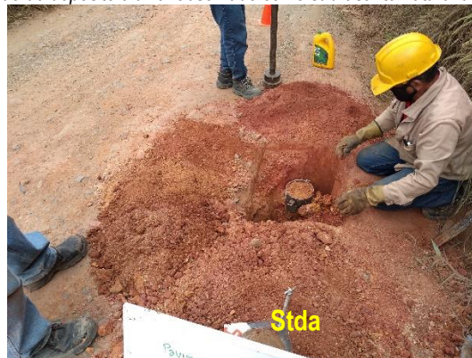
Foto 5 Suelo transportado de depósito aluvial observado como subrasante natural de la vía objeto de estudio.
